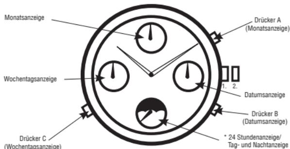
(\*) Diese Anzeige funktioniert synchron mit dem Stunden-/Minutenzeiger und muss nicht separat eingestellt werden.
